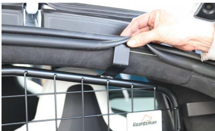
3. Legg topp brakettene under gummi pakkingen.
