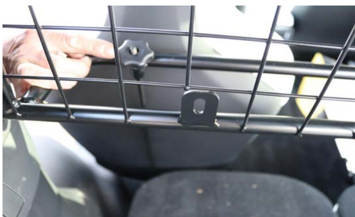
7. Sett på strammehjulet, og stram til det sitter.
